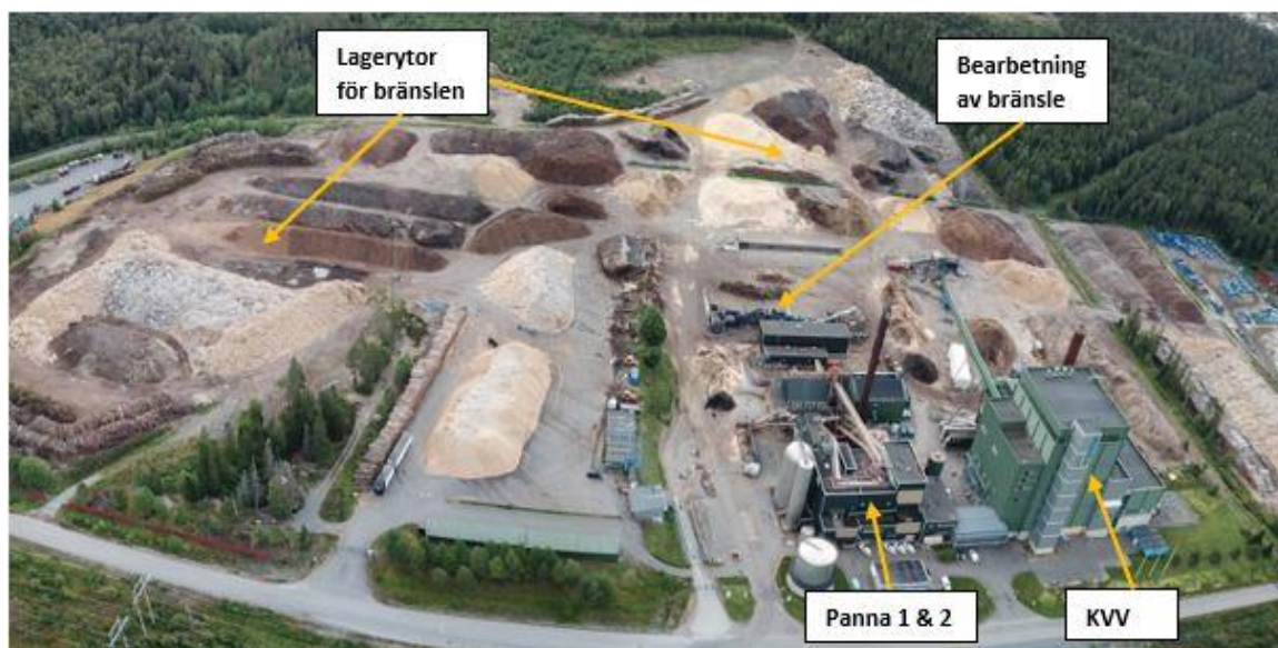
Figur 13. Översiktskarta över anläggningsdelarnas placering vid befintlig verksamhet.
