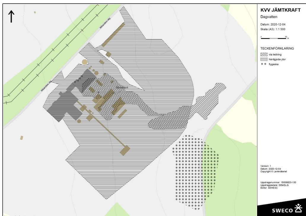
Figur 4. Asfalterade ytor samt området som hårdgjorts med flygaska.
